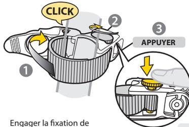
Engager la fixation de sangle dans le levier de blocage jusqu'à entendre le "Click".
